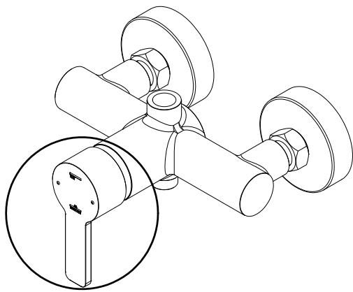
**D** Einhebelmischerkartusche wechseln.
