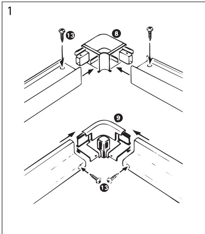
Die beiden Kunststoff-Eckverbinder Pos. 8 und Pos. 9 in das obere und untere Querprofil einer Schiebetür einstecken. Die zweite Tür rechtwinklig anstellen und an den Eckverbindern zusammenstecken und fixieren.
