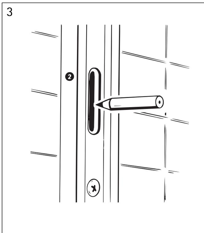
Langlöcher in den Ausgleichsschienen Pos. 2 auf den Fliesen anzeichnen; möglichst so, dass die Bohrung in einer Fliesenfuge liegt. Dann die Kabine von der Duschwanne abnehmen. Ausgleichsschienen aus dem Türprofil nehmen. Dübellöcher  $\varnothing$  6 mm bohren. (In Fliesen ohne Schlag bohren!). Dübel Pos. 7 setzen und die Schienen mit Schrauben Pos. 6 an die Wände anschrauben.
