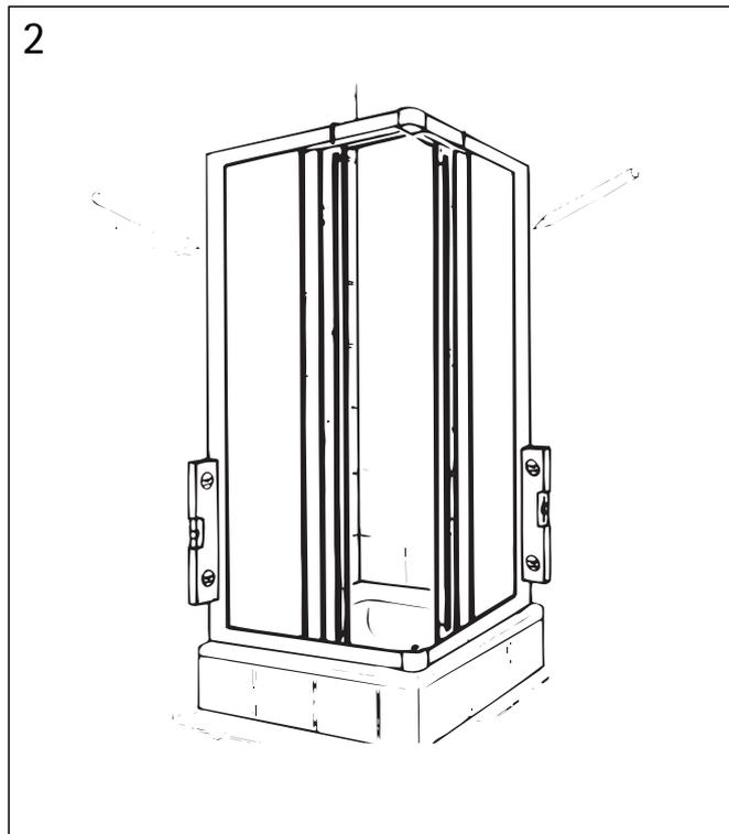
Mit einer Hilfsperson die vormontierte Kabine auf den Rand der Duschwanne stellen, an die Wände anschieben und mit der Wasserwaage exakt senkrecht und winkelig ausrichten. Der Rand der Duschwanne soll rundum etwa 5-10 mm vorstehen.
