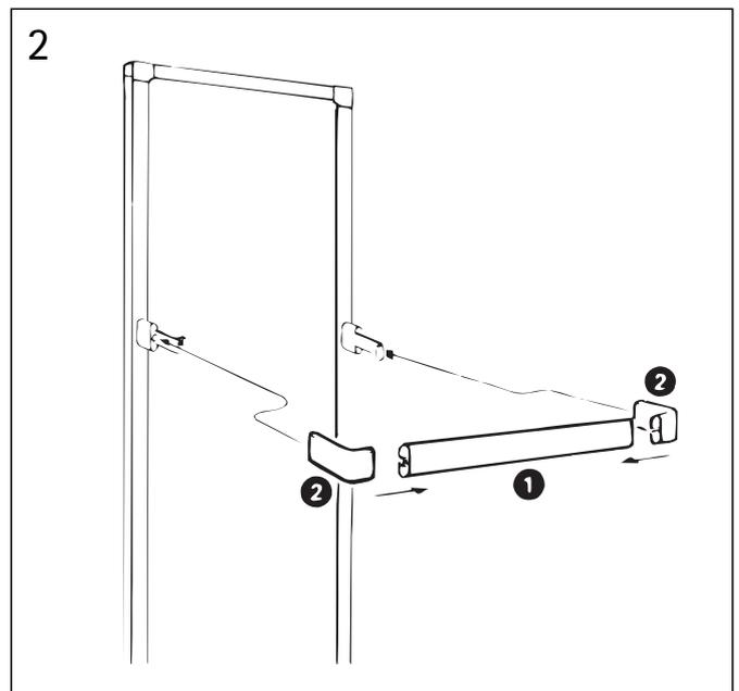
Die Seitenteile Pos. 2 des Handtuchhalters auf das Profil schieben, dabei soll die Nut im Profil nach innen zeigen. Pos. 1 Die so vormontierten Seitenteile auf die Klemmsockel beidseitig aufklipsen und ggf. rechtwinklig ausrichten.
