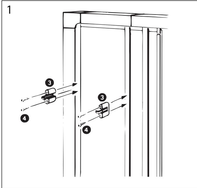
Je zwei Befestigungsbohrungen  $\varnothing$  3 mm mittig auf den senkrechten Profilen an den festen Türelementen in gewünschter Höhe anbringen.
