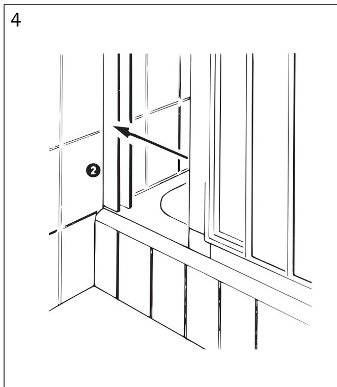
Die Kabine auf den Duschwannenrand stellen, die Schiebetürprofile nacheinander über die angeschraubten Ausgleichsschienen Pos. 2 schieben und mit den Verstell-schrauben Pos. 3 endgültig ausrichten.
