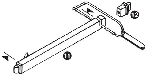
Die inneren Führungsschienen Pos. 11 müssen nach erfolgter Montage der Duschtrennung genau eingepaßt werden. Hierzu sind die jeweiligen inneren Führungsschienen von ihrem offenen Ende her so zu kürzen, dass sie 2 mm kürzer sind als die lichte Weite zwischen den beiden Auflagepunkten (bitte genau messen). Nach dem Sägen außen den Grat etwas abnehmen und nach Überprüfung der Zuschnittlänge die Lagerzapfen Pos. 12 fest in das Profil bis zum Anschlag einpressen.
