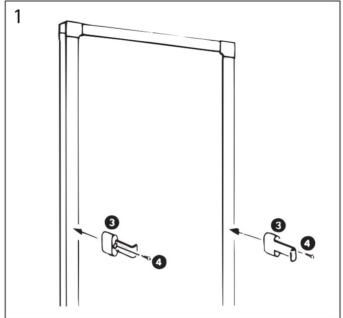
Je zwei Befestigungsbohrungen  $\varnothing$  3 mm mittig auf den senkrechten Profilen der festen Türelemente in gewünschter Höhe anbringen. Die Klemmsockel Pos. 3 mit Schrauben Pos. 4 befestigen.
