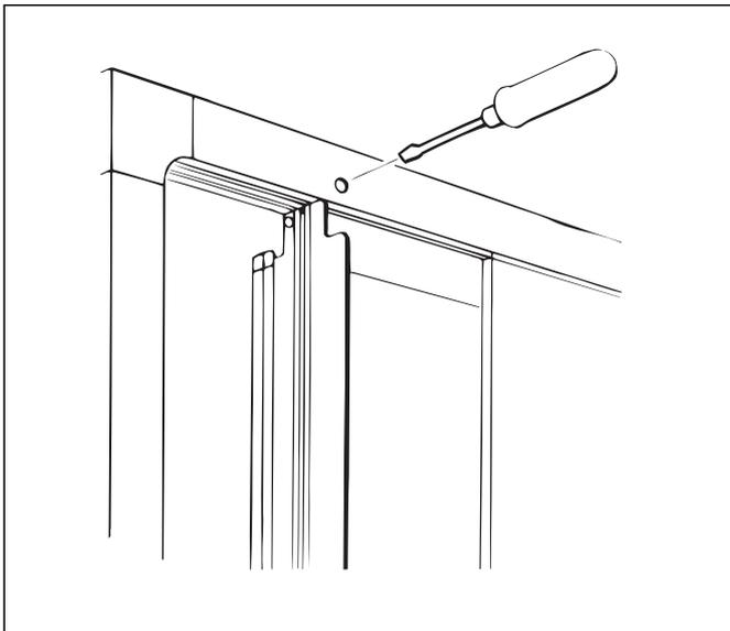
Durch die Bohrungen in der oberen Querstrebe lassen sich die Türen nachstellen. Dazu die Schrauben der Laufrollen lösen, Tür so ausrichten, dass sie von oben bis unten gleichmäßig schließt. Dann Schrauben der Laufrollen wieder fest anziehen und Öffnungen mit den Abdeckkappen Pos. 10 verschließen (eventuell mit etwas Silikon).
