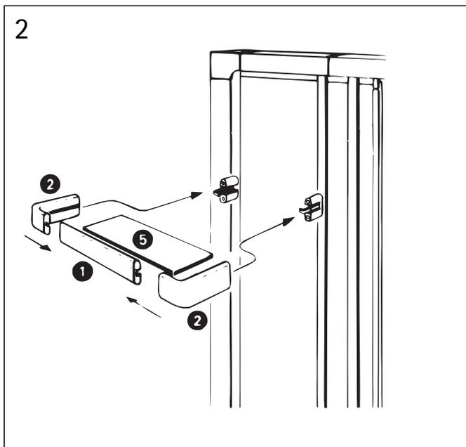
Die Klemmsockel Pos. 3 mit Schrauben Pos. 4 befestigen. Die Seitenteile Pos. 2 der Ablage auf das Profil Pos. 1 schieben, dabei soll die Nut im Profil nach innen zeigen. Ablageplatte Pos. 5 einschieben. Die so vormontierten Seitenteile auf die Klemmsockel beidseitig aufklipsen und ggf. rechtwinklig ausrichten.
