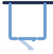
U-Kabine Drehtür mit Festteil, Nebenteil und 2 Seitenwänden
